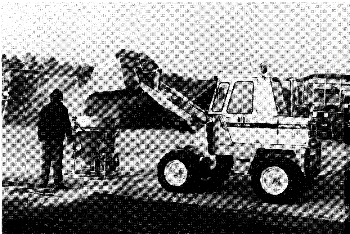
Foto 17. De bucket wordt geladen met een speciale laadschep. Op de achtergrond de container met de vrachtwagen en BAV-containers.
