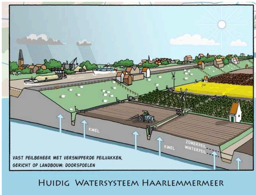
Figuur 2b Doorsnede watersysteem Haarlemmermeer (Bron: Structuurvisie Haarlemmermeer 2030)
