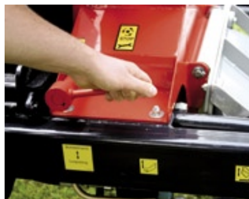
Via de omstelklep verplaats je de luchtstroom van de zuigmond naar de loopslang.
