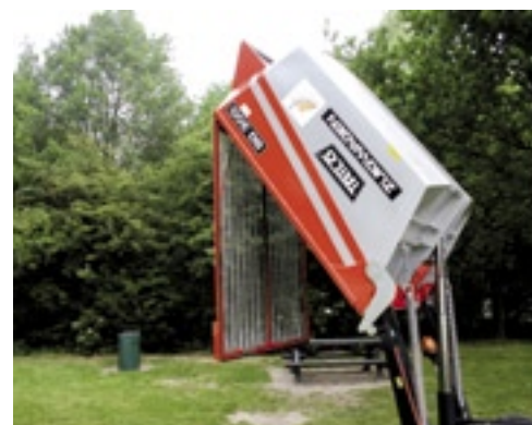
De kiepbak wordt afgedekt door een rooster dat automatisch open gaat tijdens het kiepen.
