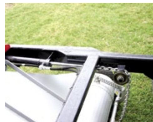
Een dubbelwerkende cilinder zorgt voor het heffen en dalen van de zuigmond.
