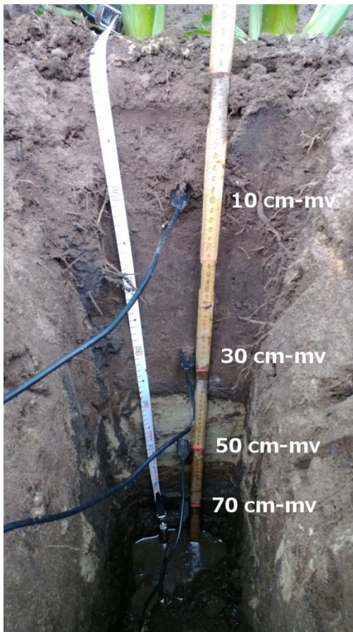
Figuur 2.9: Bodemvochtsensoren bij MP2 op vier meetdieptes.
