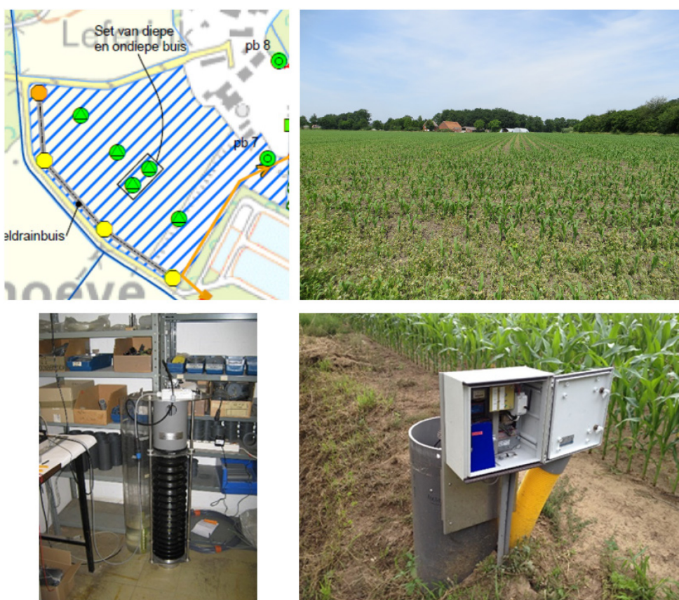
Figuur 2.3: KAD-perceel in Haaksbergen (5,8 ha). Linksboven: opzet van het KAD en in 2011 geïnstalleerde monitoringssysteem; ligging peilbuizen in groen, verzamelput in oranje, vlotterputten in geel. Rechtsboven: foto van het snijmaïs-perceel in juni 2013. Linksonder: mechanische installatie voor controle drainagebasis die geïnstalleerd wordt in de verzamelput. Rechtsonder: op afstand bestuurbare controle-eenheid met daarachter de verzamelput.
