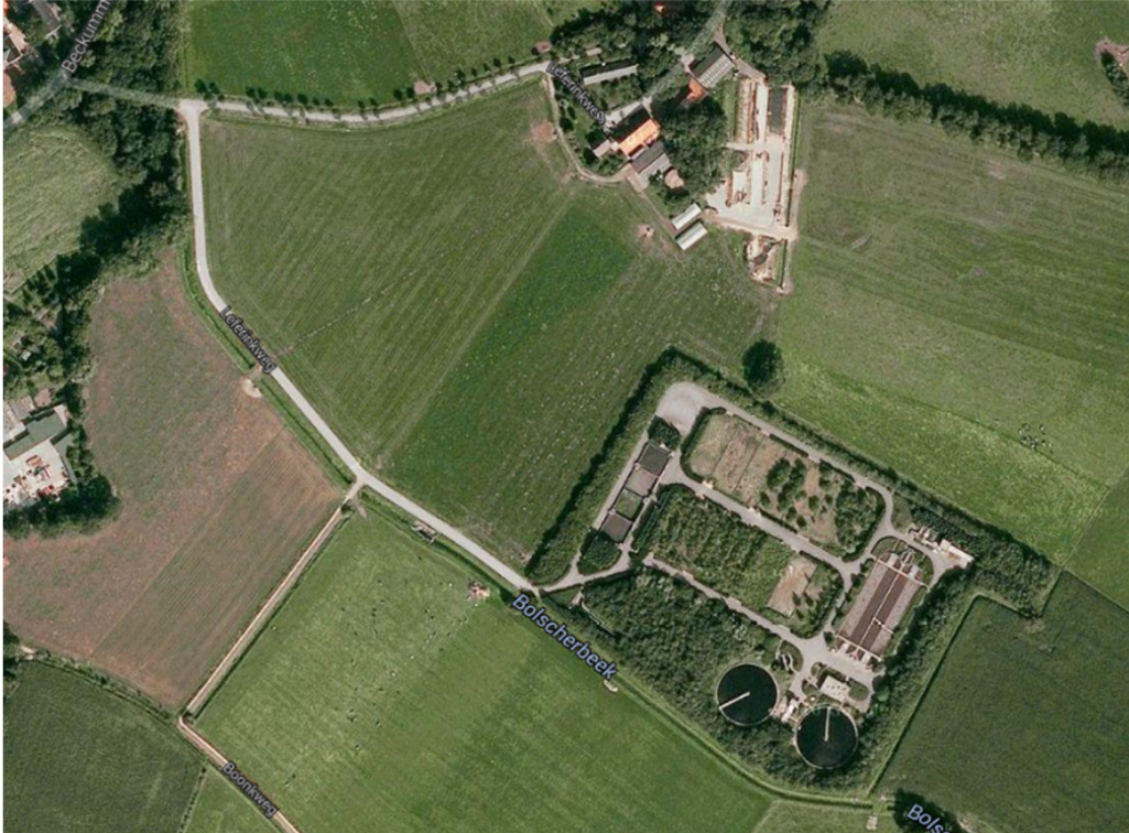
Figuur 1.1: RWZI Haaksbergen met ten noordwesten het perceel met KAD-systeem waarop een deel (5 à 6% van de Droog-Weer-Afvoer DWA van de RWZI) van de effluentstroom is aangesloten.
