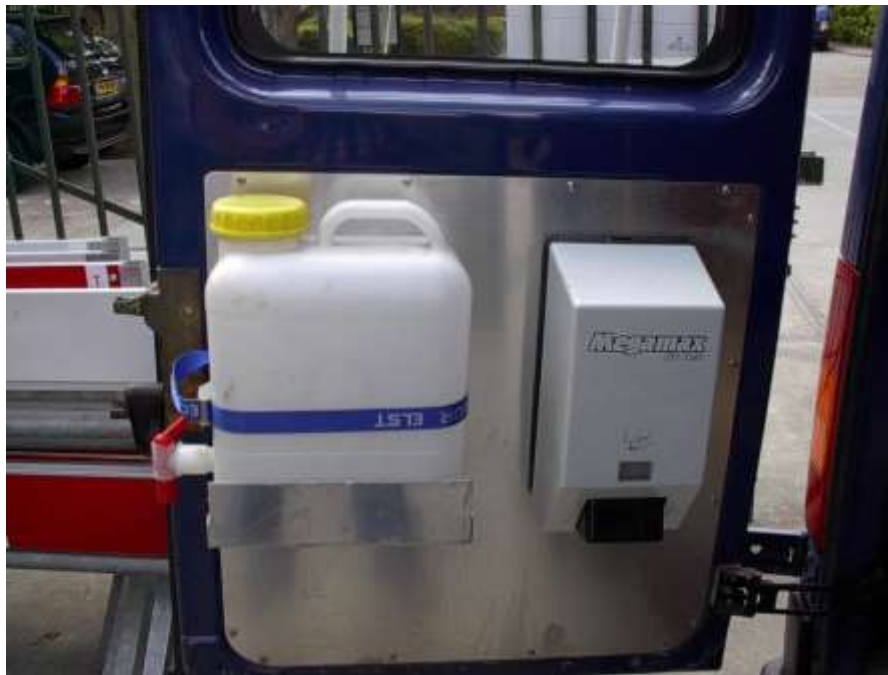
Figuur 1 Voorzieningen in een monteursbus ten behoeve van hygiënisch werken.
