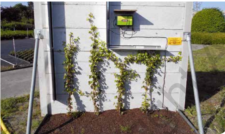
Op het PCS wordt de groeibegrenzer van GGGevelgroen bvba met klimop getest en gedemonstreerd.
