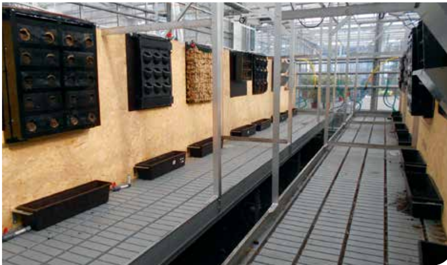
Op het PCS maakten we een proefopstelling in de serre met de acht Living Wall Systems uit onze buiten-demowand. In eerste instantie werden de systemen – zonder planten – volledig verzadigd en volgden we de uitdroging van elk paneel nauwgezet op.
