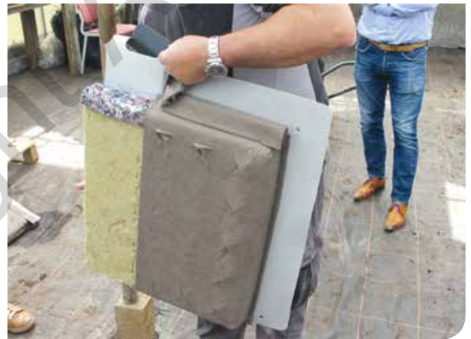
De 'flexipanelen' bestaan uit lichte en flexibele materialen zoals steenwol, vilt en een dampscherm
