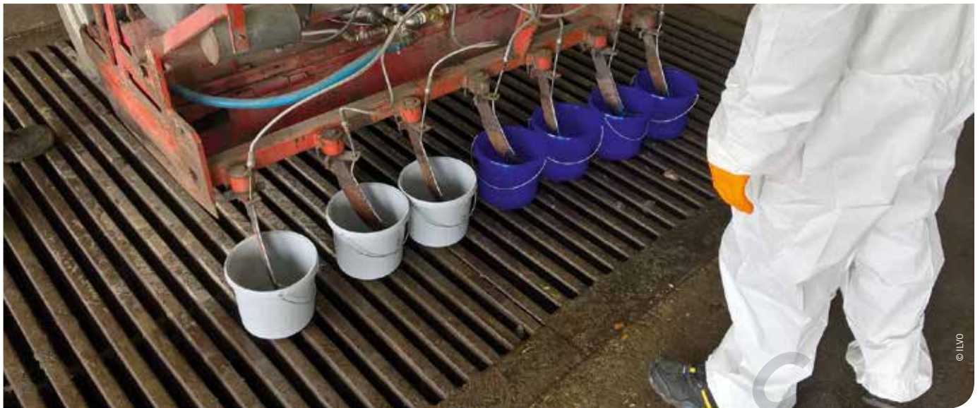
▲ Figuur 4: Verdelingsmeting van een bodemontsmettingsmachine
