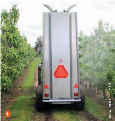
1 De OS2000 van Dominiak spuit maximum één rij ver. Hier wordt gedemonstreerd met links driftreducerende en rechts gewone doppen. 2 De Cross Flow van H.S.S. heeft blaasmonden die zorgen voor een optimale bedekking en een gelijke verdeling links-rechts en boven-onder. Daardoor moet men veel minder wind maken om een goede verdeling te krijgen. 3 Désiré Simons vindt dat wie spuit zijn verantwoordelijkheid moet nemen. De richtbare blaasmonden van de Munckhof triple fan bieden als voordeel dat ze kunnen gericht worden naargelang de grootte van de bomen.
