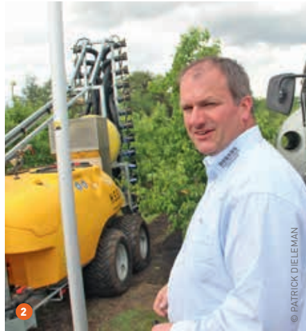
1 De OS2000 van Dominiak spuit maximum één rij ver. Hier wordt gedemonstreerd met links driftreducerende en rechts gewone doppen. 2 De Cross Flow van H.S.S. heeft blaasmonden die zorgen voor een optimale bedekking en een gelijke verdeling links-rechts en boven-onder. Daardoor moet men veel minder wind maken om een goede verdeling te krijgen. 3 Désiré Simons vindt dat wie spuit zijn verantwoordelijkheid moet nemen. De richtbare blaasmonden van de Munckhof triple fan bieden als voordeel dat ze kunnen gericht worden naargelang de grootte van de bomen.
