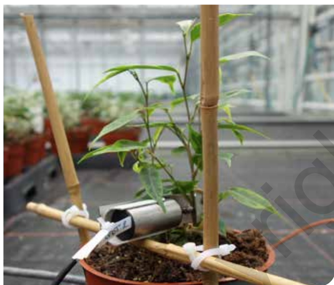
▲ Figuur 1: Sensor voor meting stengeldiameter geïnstalleerd op Ficus benjamina
