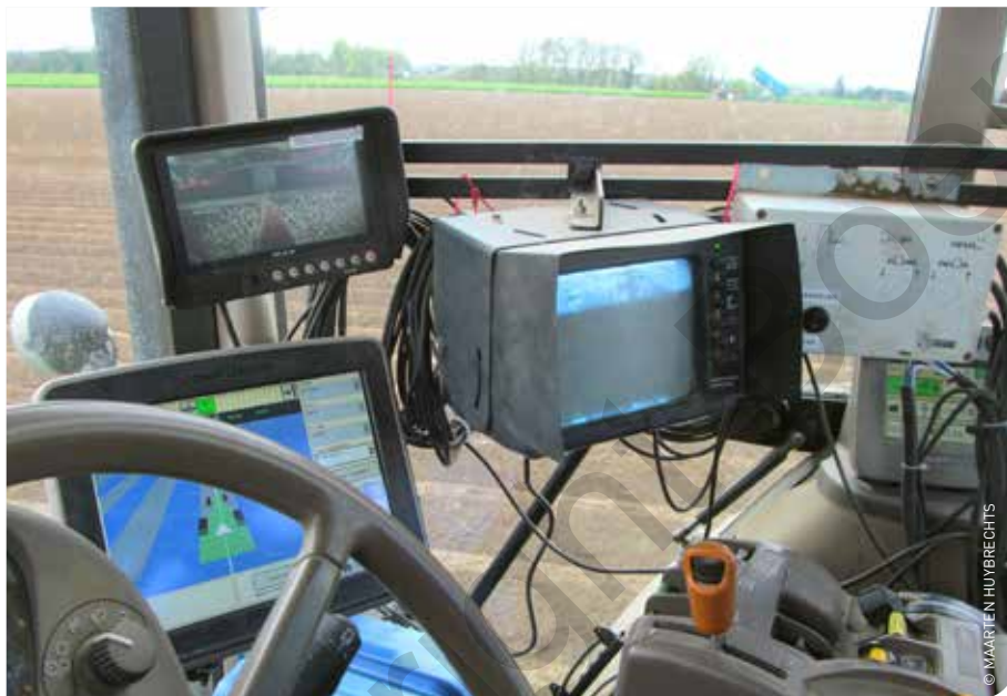
Wanneer de tractor op RTK rijdt, kan de bestuurder op een ontspannen manier toezicht houden op het planten zelf. Enkele camera's tonen niet-zichtbare plekken.
