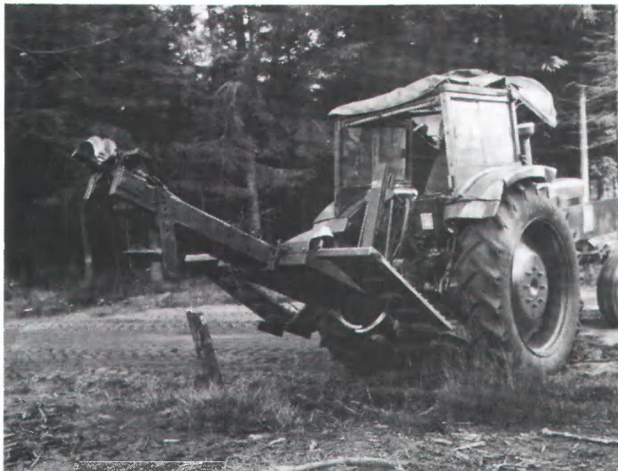
Afb. 3 Transport van de snoei- plaat. Transportation of the delimiting unit.
