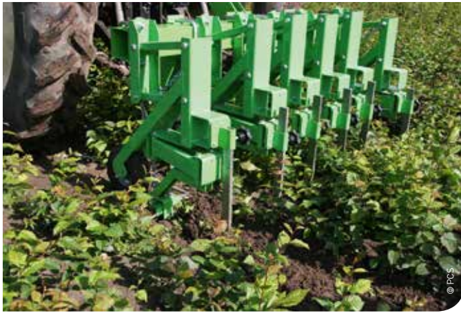
▲ Mechanische onkruidbestrijding in bosgoed
