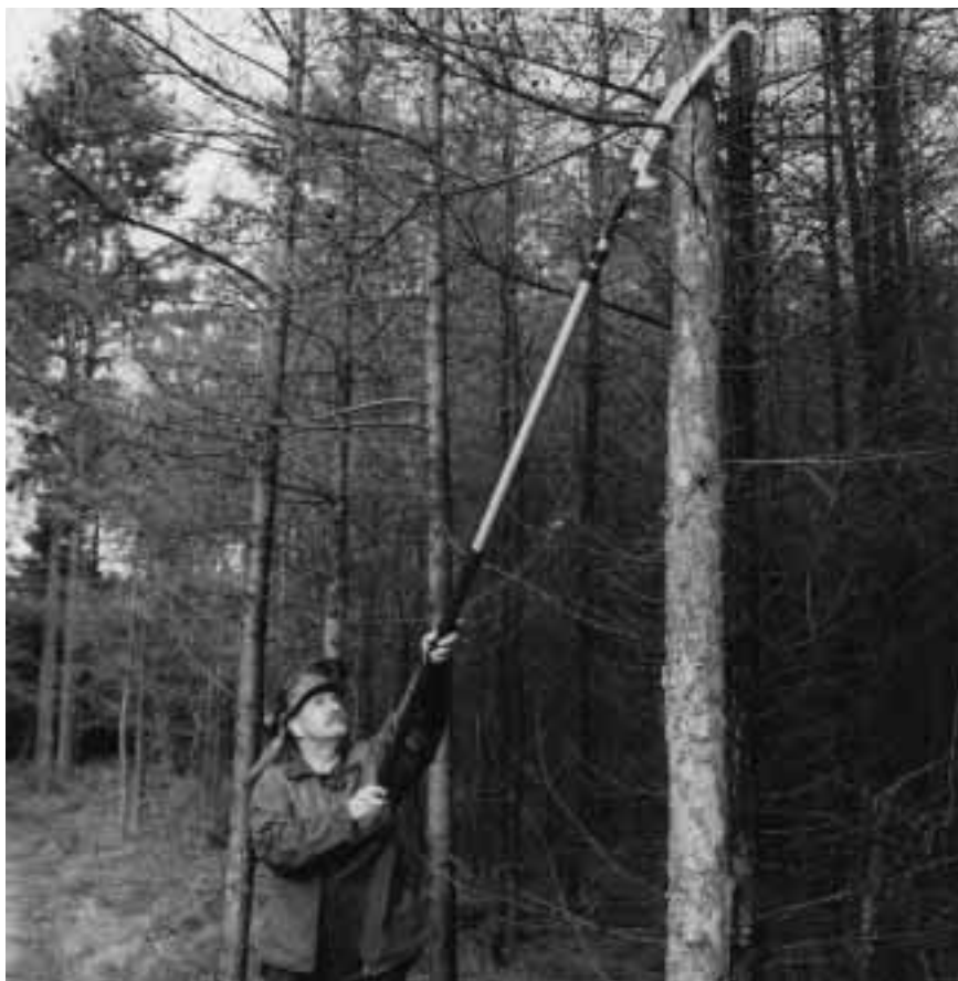
In Nederland wordt momenteel vooral de handzaag gebruikt tot 2,5 meter en de stokzaag tot maximaal 6,5 meter. Foto: Stichting Bos en Hout.
