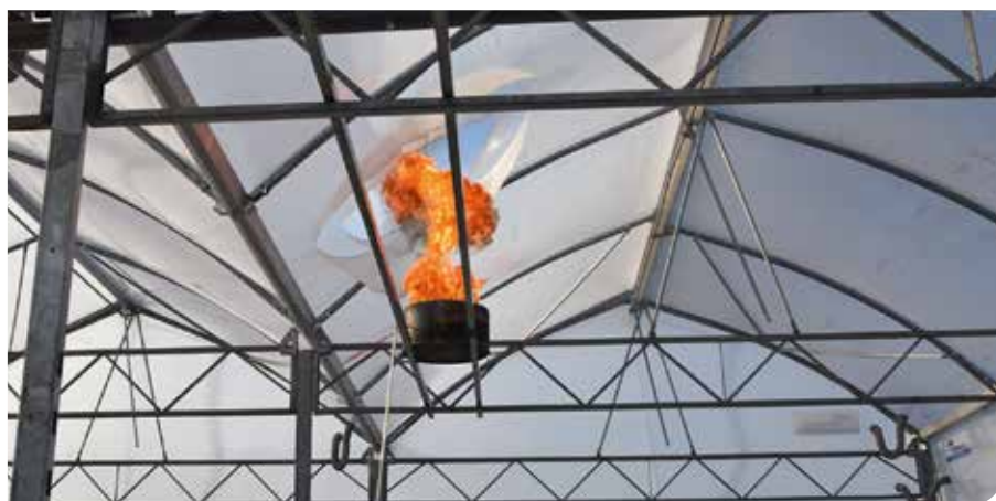
▲ De resultaten van de brandproef bij de firma Vermako waren in die aard positief dat een eerste aanvraag voor afwijking van een serre met dubbele folie werd goedgekeurd.
