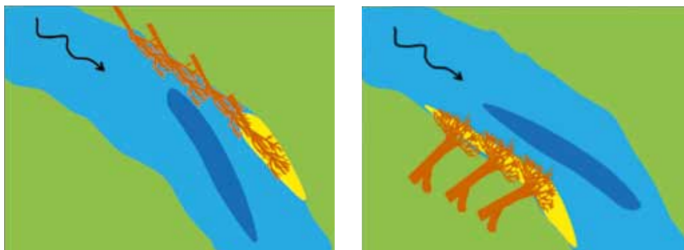
FIGUUR 4.2 | Oeverbeschoeiing met boomstammen in de lengterichting (links) of boomstobben tegen de stroomdraad (rechts).
