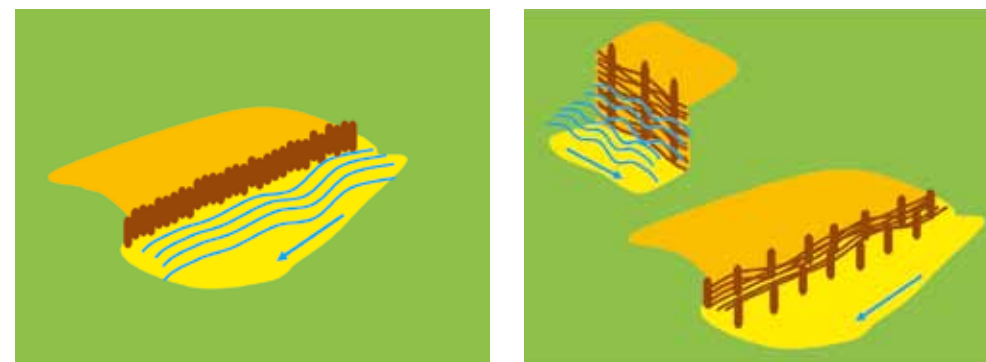
FIGUUR 4.1 | Oeverbeschoeiing met paaltjes (links) of vlechtwerken van wilgentenen (rechts).
