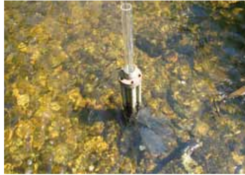
FIGUUR 6.1 | Grindbed in een beek met een meetbuis om de interstiële ruimtes in de bedding te kunnen bemonsteren.
