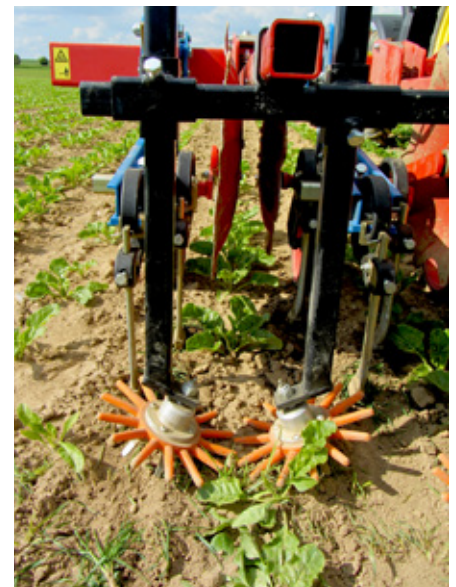
Met schoffelen en vingerwieders wordt het onkruid tussen en in de rijen bestreden.
