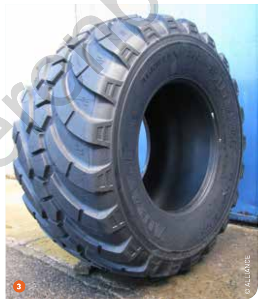
1 Het slimme wiel van Trelleborg en Fendt bevat in de velg een compressor die de druk constant bijstuurt. 2 en 3 De Alliance 389 VF-band probeert lage druk te combineren met hoog laadvolume. Op 0,8 bar is 3500 kg belasting toegelaten.
