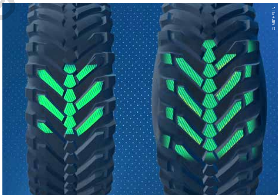
Door het scharniereffect wordt het contactvlak van de Michelin EvoBib 20% groter op lage druk.
