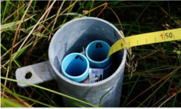
Meetpunt met twee peilbuizen.
