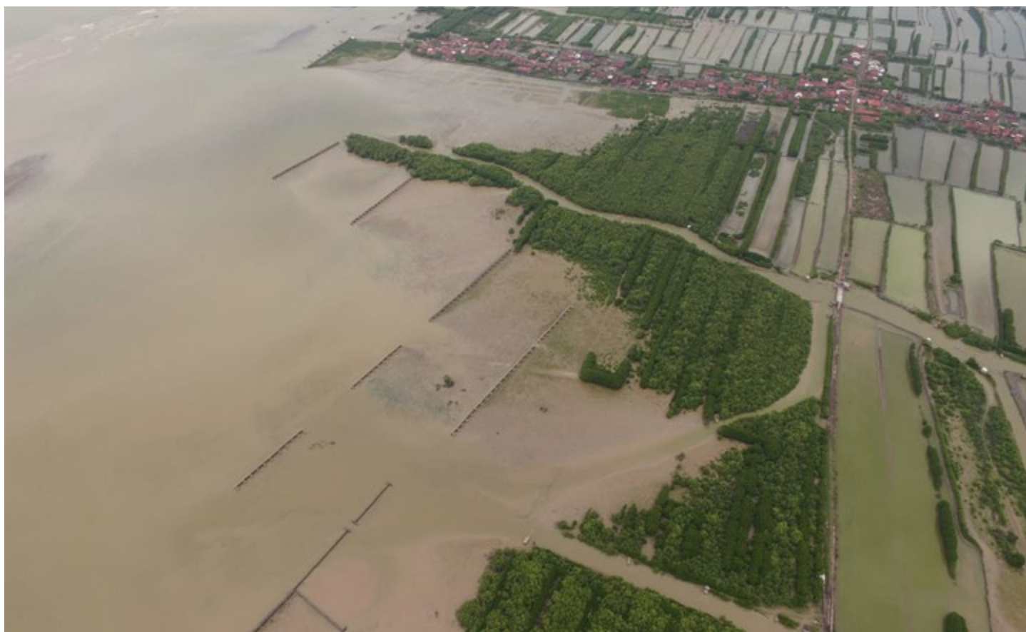
Dronefoto van het mangrove-herstelproject aan de noordkust van Java, bij de stad Semarang. In het water zijn de halfdoorlatende dammetjes zichtbaar, die slib invangen, waarin mangrovezaad kan kiemen.
