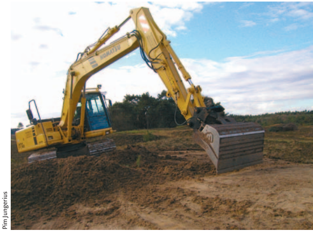
Figuur 5 De voordelen van een kraan met kantelbak: een golvend reliëf is geen bezwaar, de brede tracks veroorzaken weinig schade en de kantelbak kan een dunne plag afsteken. De methode is zeer geschikt voor het verwijderen van buntgras en mossen.
