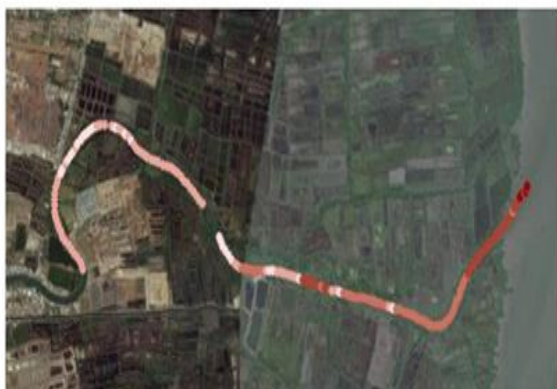
Afbeelding 6a. Meetresultaten geleidbaarheid in rivier naar zee; 6b. Diepteprofiel
