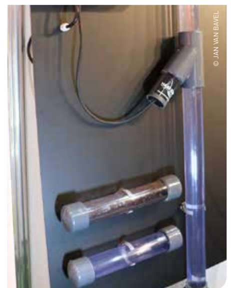
De opstelling van het Harsonic-systeem op de EuroTier-stand, met in het midden de transducer die de specifiek gekozen frequenties met bepaalde intervallen uitzendt.
