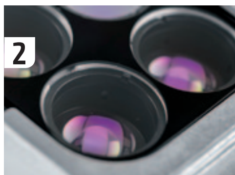
Door middel van infrarood en spectroscopie meten de sensoren de wegdekconditie.
