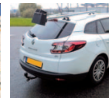
Met magneten kan de sensor ook op een personenauto gemonteerd worden.
