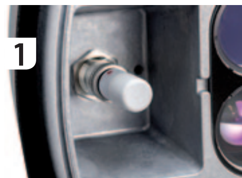
De witte sensor meet de temperatuur en de relatieve luchtvochtigheid.
