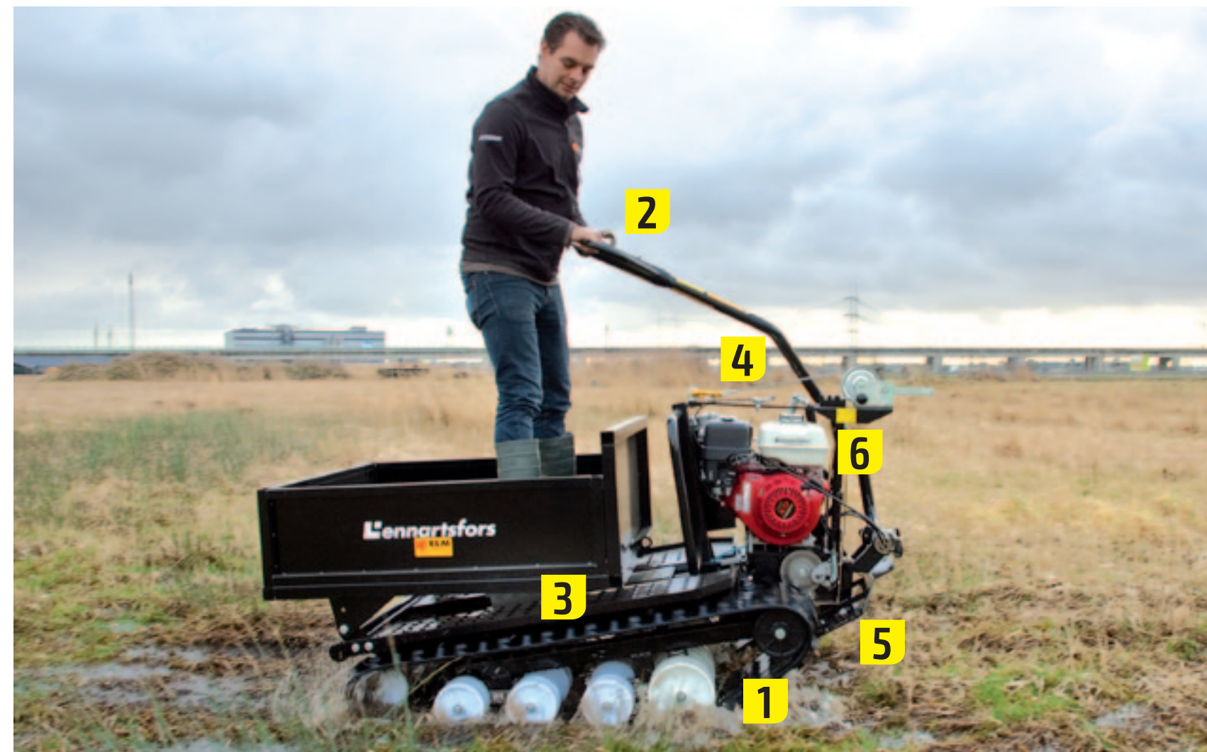
5 De stalen plaat onder het motorblok voorkomt dat de machine voorover kantelt zodra je ongeladen een helling af rijdt. Tijdens de proefrit blijkt dat deze plaat onmisbaar is.
