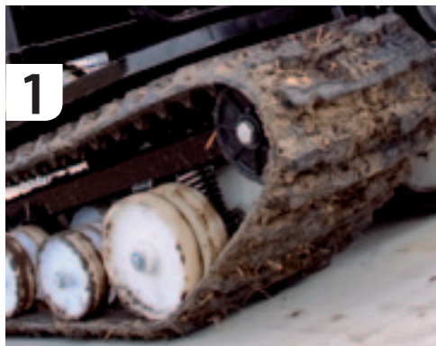
1 Dankzij de hoek van de rups klimt de Flex tegen hellingen op en rijdt moeiteloos over drassige ondergronden.
