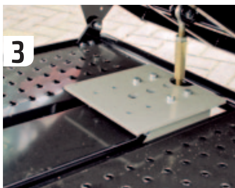
3 Door de schotelkoppeling hydraulisch naar achter te schuiven kiept de grondbak. En bij een trailer kun je het gewicht beter over de machine verdelen.
