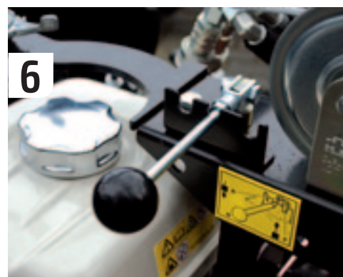
6 Met de hendel zet je de machine in zijn voor- of achteruit. Vervolgens is het kwestie van gas geven en rijden maar.
