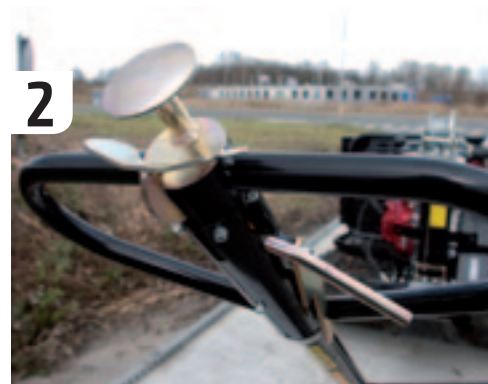
2 Op de stuurboom zitten de rijhendel, de remhendel en de dodemansknop. Door de remhendel vast te zetten met een beugel zet je de machine op de handrem.
