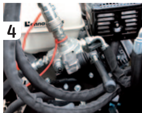
4 Met de hendel aan de zijkant bedien je de horizontale cilinder van de schotelkoppeling. Bij een grondbak kun je met deze hendel kiepen.
