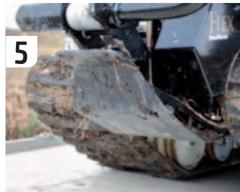
5 De stalen plaat onder het motorblok voorkomt dat de machine voorover kantelt zodra je ongeladen een helling af rijdt. Tijdens de proefrit blijkt dat deze plaat onmisbaar is.
