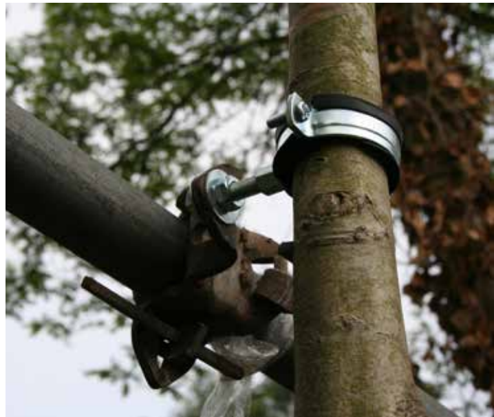
De cv-klem om de bomen rechtop te houden; onderin zijn de bomen met autogordel vastgezet.
