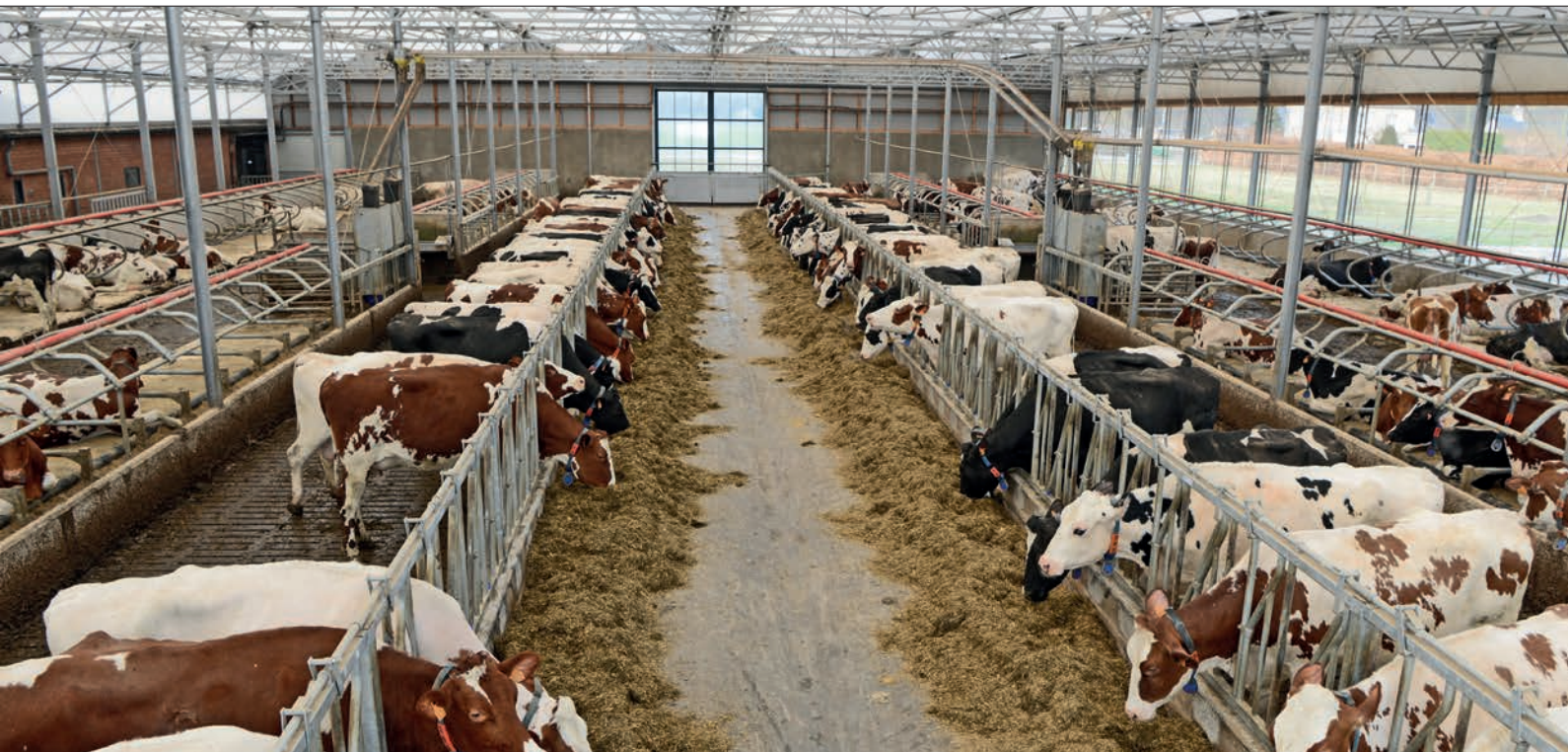
Door de centrale voergang kunnen de koeien gemakkelijk in twee productiegroepen worden opgedeeld
