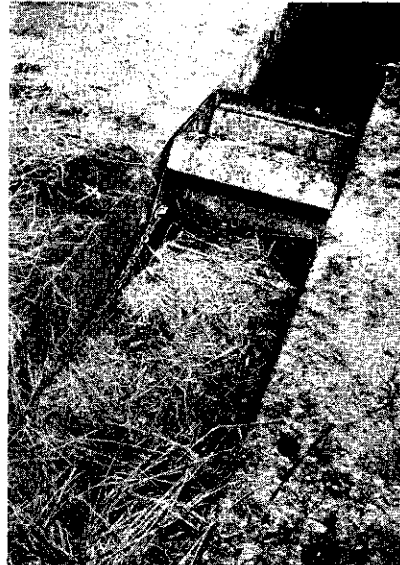
Afb. 5. Mestschuif zonder bodem en met opklapbaar achterschot. De schuif wordt mechanisch heen en weer getrokken.
