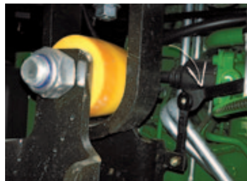
Onder de cabine een sensor die continu de verandering van de cabine meet ten opzichte van de achterbrug.
