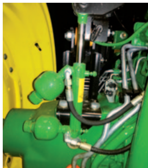
De twee accumulators zorgen ervoor dat de in- en uitgaande beweging van de veercilinder worden gedempt.
