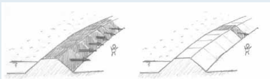
Figuur 2. Illustratie van het lengte-effect: de kans dat het ergens in de dikring misgaat, is groter dan de kans dat het op één specifieke plaats misgaat.
