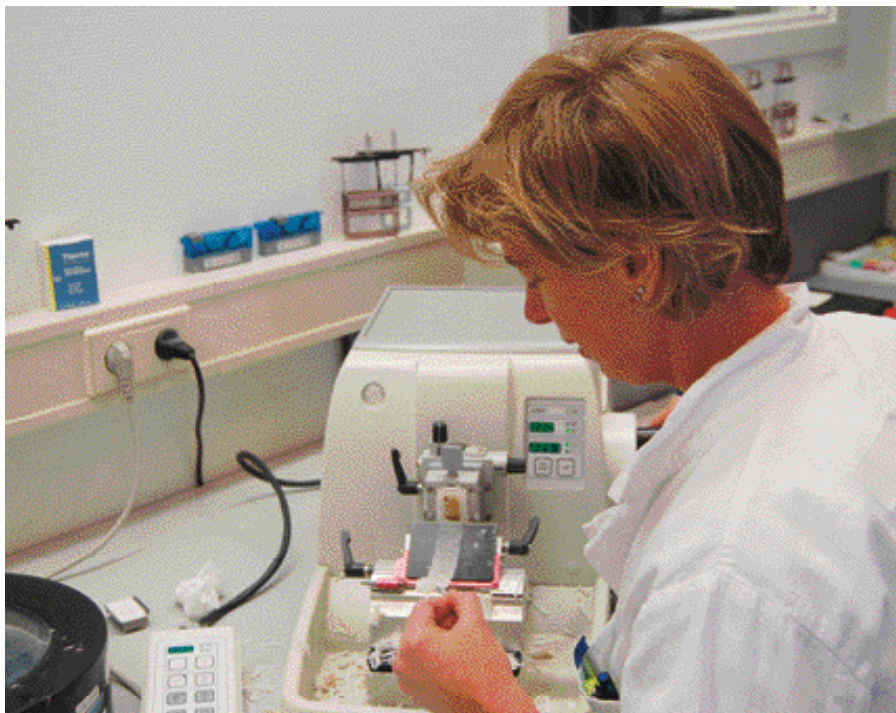
Histologisch laborant Annette van Drie snijdt van het gefixeerde weefselmateriaal een plakje van enkele micrometers dikte om microscopisch te kunnen beoordelen.
