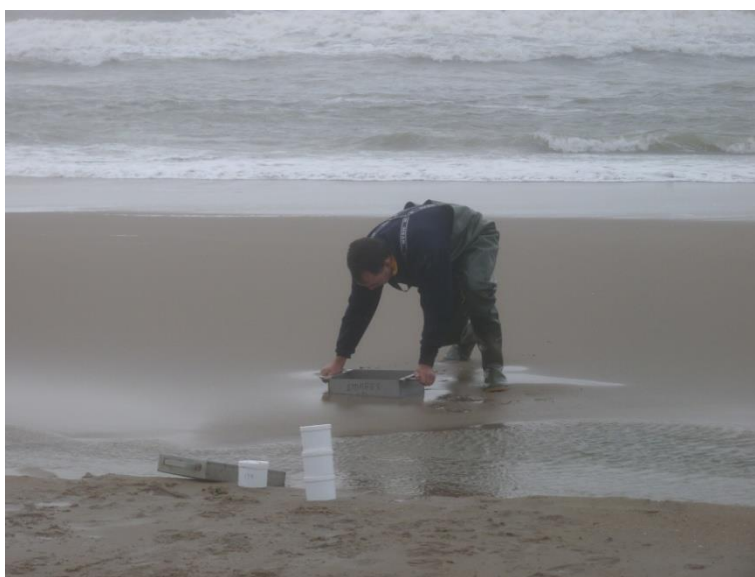
Figuur 5: Monstername strand. Te zien is hoe het rvs meetframe in de bodem wordt gedruwd.
