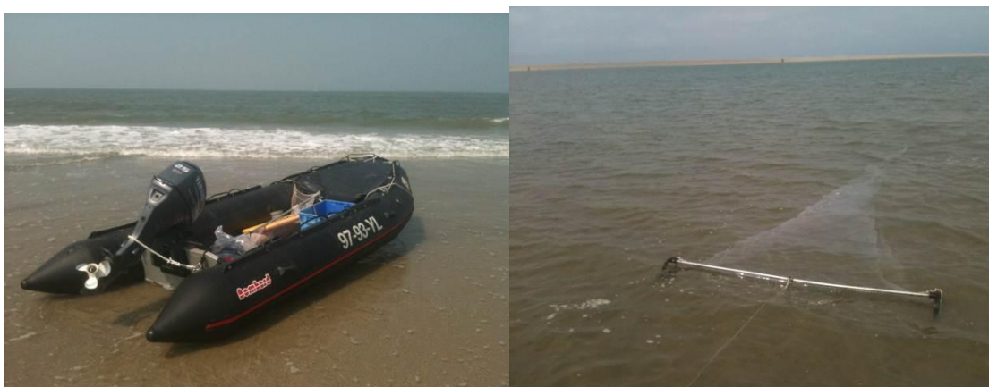
Foto 2. Links: De 4,5 meter lange rubberboot Bombard C5 met 25 pk motor. Rechts: twee meter boomkor.
