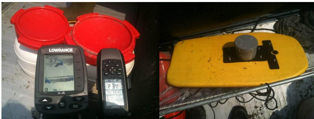
Foto 3. Links: Lowrance X4 dieptemeter en Garmin GPS. Vissen aan boord worden tijdelijk opgeslagen in de witte tonnen met rode deksel. Rechts: Logger in een PVC behuizing op het body-board.
