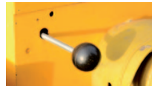
De transmissie heeft twee toerentallen. Je schakelt ze in met deze hendel op de versnellingsbak. Hij is naast de aftaktussenas te vinden.
