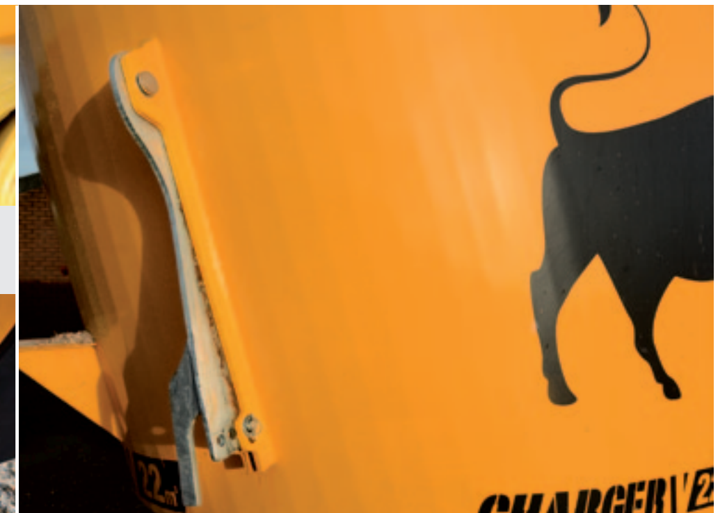
De Charger V22 heeft twee tegenmesses. In dit geval zijn ze met de hand te bedienen. Een hydraulisch bediende versie is ook leverbaar. Net als een programmeerbaar tegenmes. Dan snijdt het mes het voer gedurende een bepaalde tijd. Is het voer gesneden, dan trekt het mes zich terug. Dat spaart vermogen.
