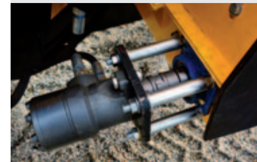
De hydromotoren met hun klauwkoppelingen zijn niet direct op de losband gemonteerd. Het moet wiikkelen van gras en extra slijtage voorkomen.
