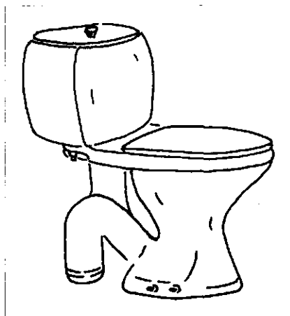
Afb. 4 - Closetcombinatie, stortbak en closetpot tot één geheel verbonden.
