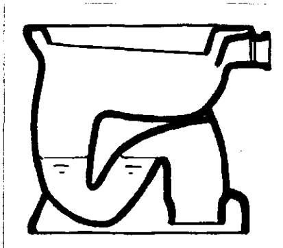
Afb. 2 - Voorbeeld dwarsdoorsnede van een schotelclosetpot met achter-onder-uitlaat.
