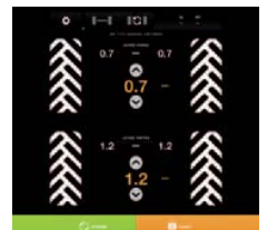
Minimum- en maximumwaarden Bij instellen voor zowel de straat als de akker zie je de actuele en ingestelde waarden. Tijdens meten knipperen de waarden. De ingestelde minimum- en maximumwaarden kun je beveiligen met een pincode.
