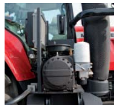
Extern De compressor inclusief aansturing en oliekoeler zou je kunnen beschouwen als een extra werktuig aan de trekker. Meestal wordt het geheel rechts naast de cabine gemonteerd.
