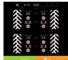
Onafhankelijk De bandenspanning voor straat en akker kun je per band instellen. De trekker op de grote foto staat scheef (zie bovenstaande waarden). Zo staat de trekker vlakker op een helling of heb je hardere banden in de ploegvoor.
