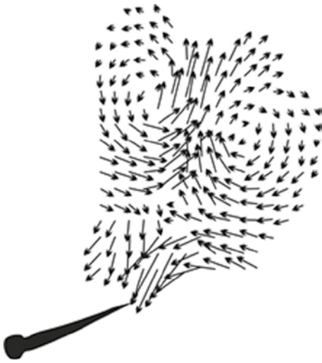
Figuur 3. Het stroompatroon als gevolg van een staarts slag van een vislarve.
