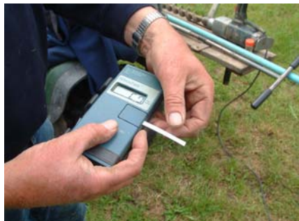
Figuur 3 Met het sneltestapparaat Nitrachek 404 bepaalt men met teststrookjes het nitraatgehalte van het grondwater
