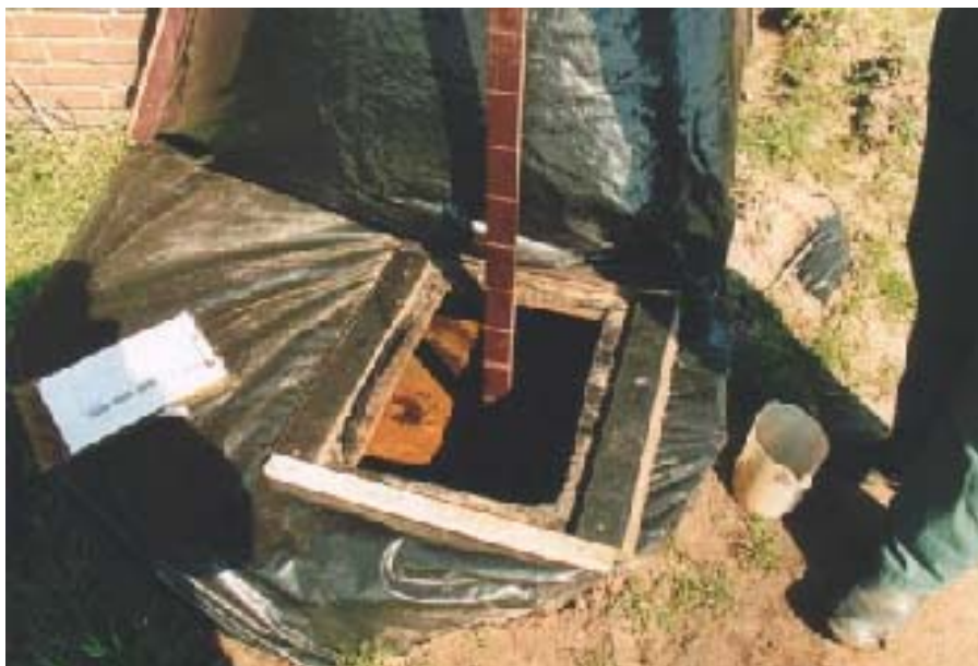
Foto 2: Meting van vloeistofniveau lekvocht.
