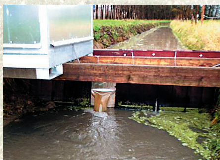
Stuw voor het meten van de slootafvoer
