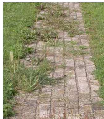
Afbeelding 5. Klinkers met Geomix voegvulling (links) en klinkers met een standaard brekerzand voegvulling (rechts), twee jaar na aanleg. Foto's proefveld: Plant Research International.
