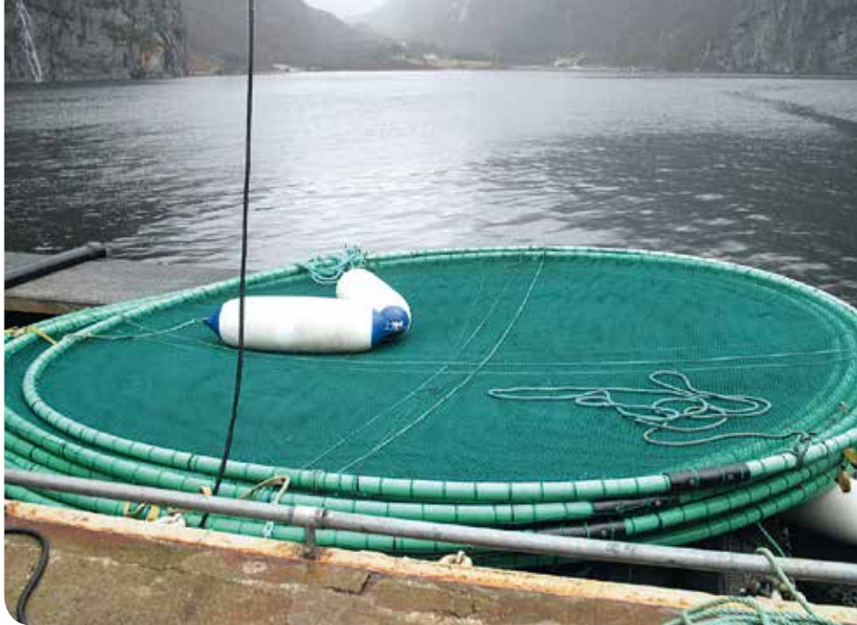
Een schap voor extra ligruimte in de kooien, hier op het droge gefotografeerd.
