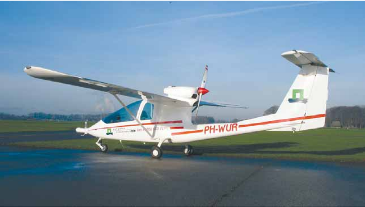
De Sky Arrow van Alterra heeft speciale meetapparatuur om concentraties broeikasgassen te meten. / foto Alterra
