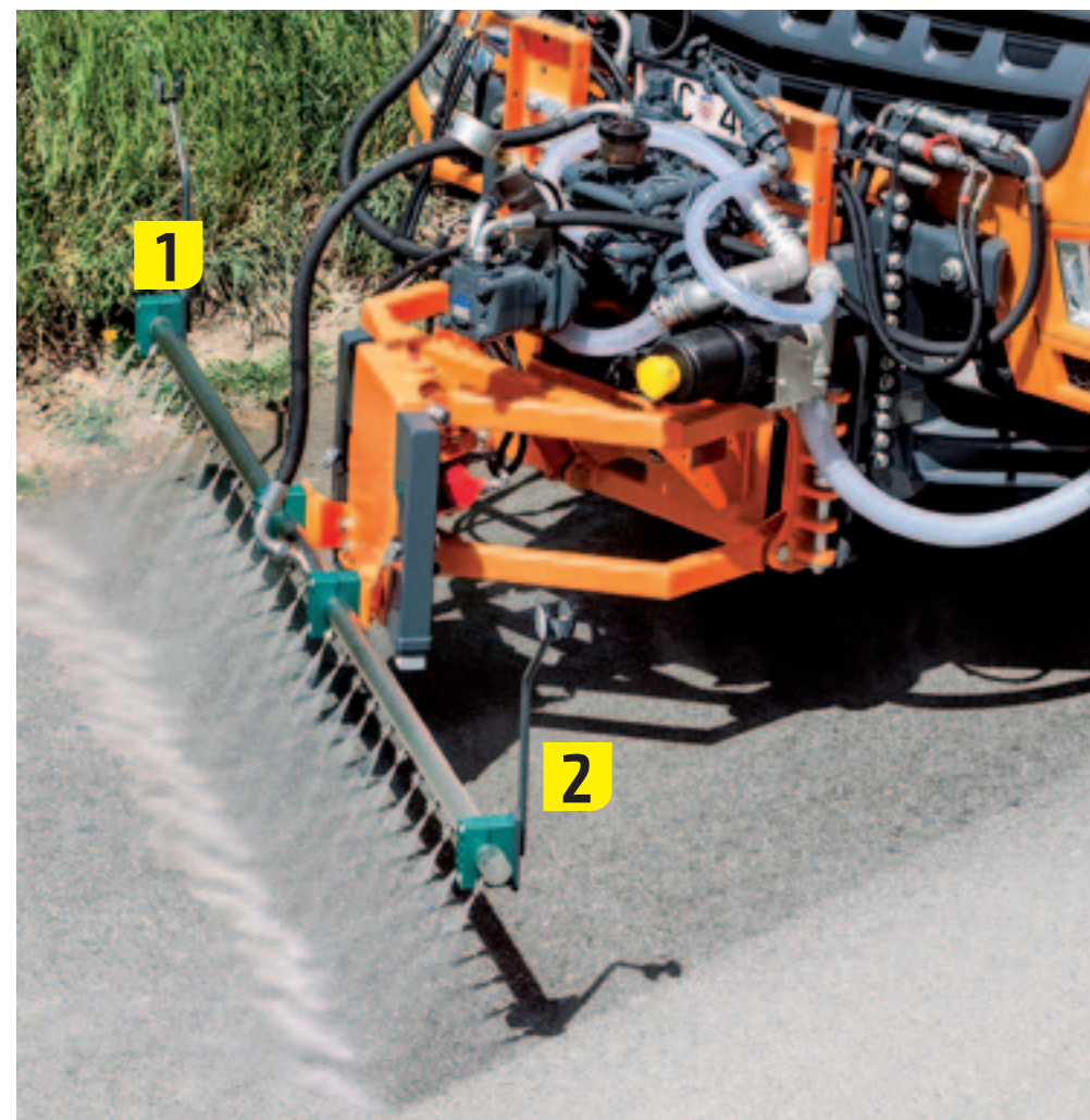
Op de hoek van de spuitboom kan een 'frog nozzle' worden gemonteerd. Deze spuitmond spuit een grote hoeveelheid water in een brede straal. Zo kun je met de spuitboom ook asfalt koelen.
