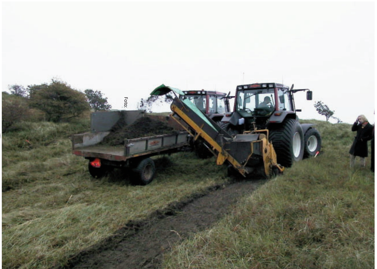
Op het Rozenwaterveld domineerden duinroosjes en duinriet. Met relatief lichte apparatuur is ongeveer vijf centimeter afgeplagd. Foto: Mark van Til.
