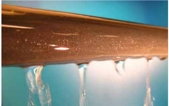
Water verlaat een keramisch membraan
