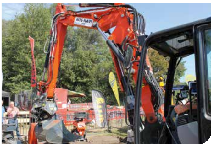
De Oilquick 45-5 weegt 85 kg en is geschikt voor graafmachines van 5 tot 12 ton en wordt elektrisch bediend vanuit de cabine.
