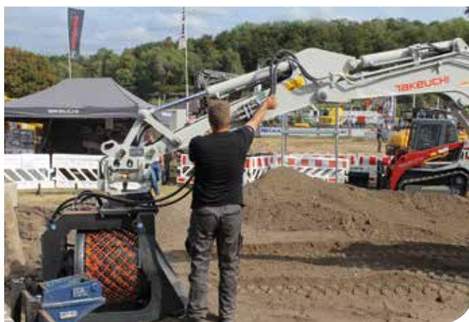
Dit systeem is één van de meest gebruikte in Europa. Voor hydraulische uitrustingsstukken worden de olieleidingen manueel gekoppeld.
