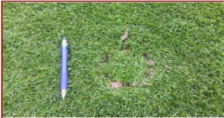
Etat de la surface après l'essai de résistance en traction rotationnelle
