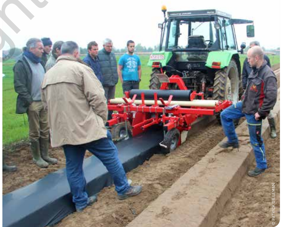
Nadat de machine een eindje gereden had, lichtte Tom van den Beuken van Deto (rechts) de werking toe. Vooraan is goed te zien dat het profiel van de ruggen licht afloopt naar beide zijden.
