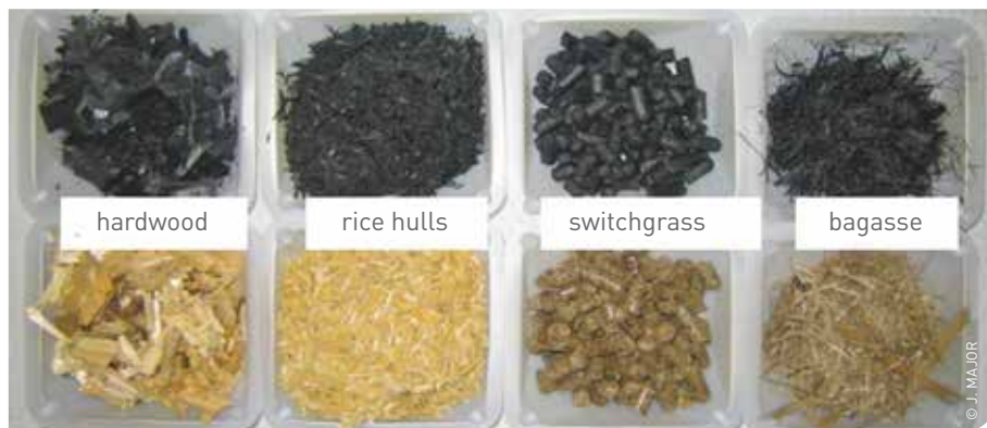
Diverse vormen van organisch materiaal kunnen door ze te verhitten tot temperaturen van 450 tot 550 °C, in afwezigheid van zuurstof, verkolen en worden omgezet naar biochar.
